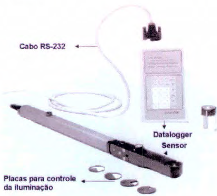
Fig.7.6 – Foto do LAI - 2000 e principais componentes. FONTE: Lincon (1992)
